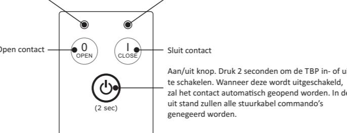
Aan/uit knop. Druk 2 seconden om de TBP in- of uit te schakelen. Wanneer deze wordt uitgeschakeld, zal het contact automatisch geopend worden. In de uit stand zullen alle stuurkabel commando's genegeerd worden.
