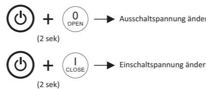
Durchlaufen Sie die Spannungswerte, indem Sie die Tasten 'OPEN' (oben) oder 'CLOSE' (nieder) drücken
